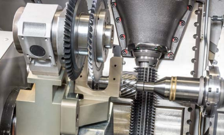
Integriertes Drück-Wälzentgraten für optimale Verzahnungsqualität durch 2-Schnittstrategie.
